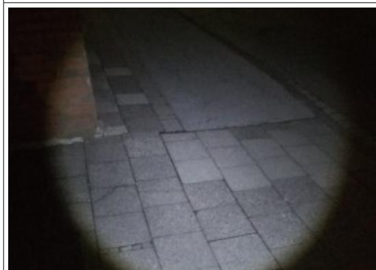
An einer Stelle geht der rote Radweg in einen Grauen über, der dann plötzlich endet. Eine sichere Überführung auf die Straße fehlt völlig. **An dieser Stelle besteht bereits durch PKW Lebensgefahr.** Der graue Radweg schränkt an dieser Stelle den Gehweg auf 60 cm ein, sodass dieser als nicht nutzbar zu werten ist.
